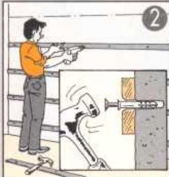
2 Après perçage des tasseaux et du mur, fixez les tasseaux contre le mur avec des chevilles auto-forieuses.
