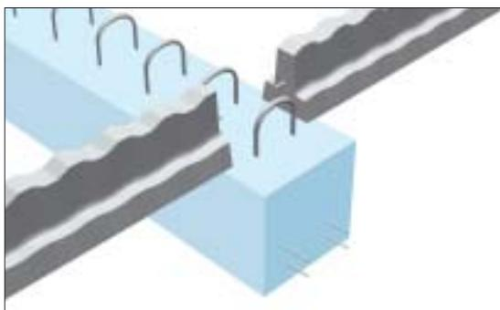
Poutres en béton précontraint de 20 x 20 cm, disponibles sur stock de 10 en 10 cm, avec un poids au ml de 100 kg. Appuyées sur un mur ou sur un poteau, elles supportent un plancher à poutrelles. Selon les charges à reprendre, elles sont calculées avec ou sans table de compression associée.
