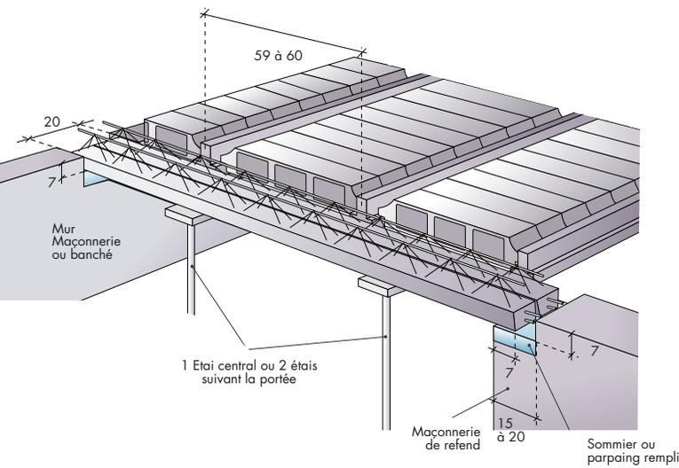
Poutres en béton précontraint de 7 cm de retombée, posées en montage jumelé, disponibles sur stock de 10 en 10 cm. Leurs poids est de 17 kg par ml. Appuyées sur un mur ou sur un poteau, elles supportent un plancher à poutrelles. Selon les charges à reprendre, elles sont calculées avec ou sans table de compression associée.
